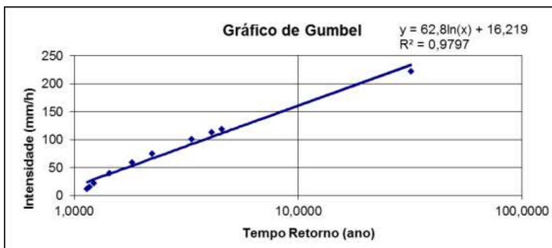
Figura: 2: Correlação entre Tempo de Retorno (ano) e intensidade de chuva (mm/h).
